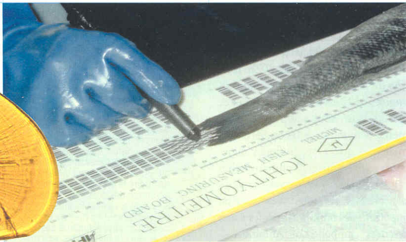
▲ La règle électronique échantillonne la taille des poissons. Puis, avec les données sur leur âge, on évalue la démographie des captures et on en déduit l'effectif du stock.
